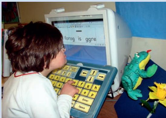
Intellikeys sind programmierbare Tastaturen. Sie besitzen eine druckempfindliche Tastaturoberfläche, die individuell an die Bedürfnisse und Fähigkeit des Anwenders angepasst werden kann. Tastaturschablonen, sog. Overlays, ermöglichen unterschiedliche Nutzungsvarianten.
