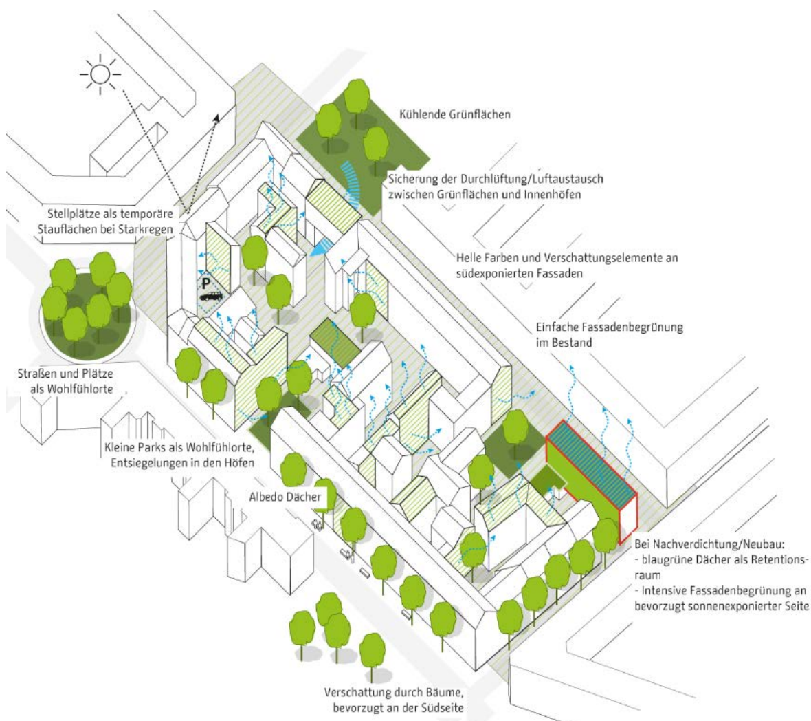
Abbildung 55: Mögliche Anpassungsmaßnahmen im Stadtstrukturtyp Verdichtete Blockrandbebauung, StEP Klima KONKRET; Quelle: STEP KLIMA KONKRET, SENSTADTUM/BGMR 2016.
