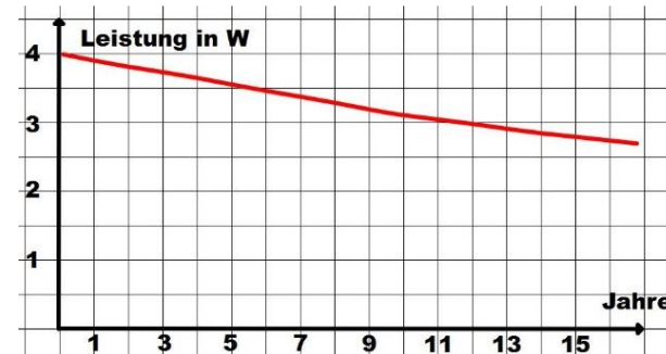
Leistung der Batterie über 15 Jahre
