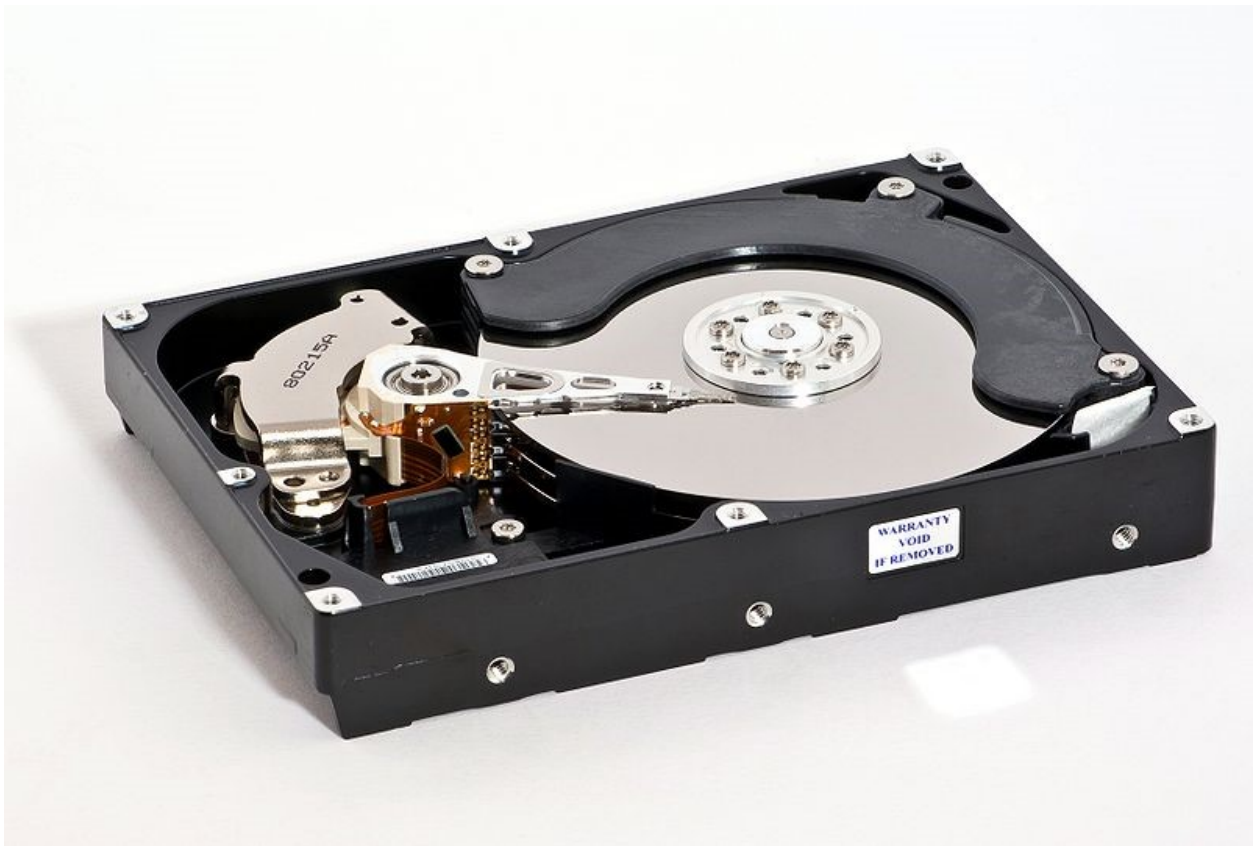
Das geöffnete Gehäuse einer Samsung-HD753LJ-Festplatte, Christian Jansky, CC BY-SA 3.0 https://creativecommons.org/licenses/by-sa/3.0 , via Wikimedia Commons
