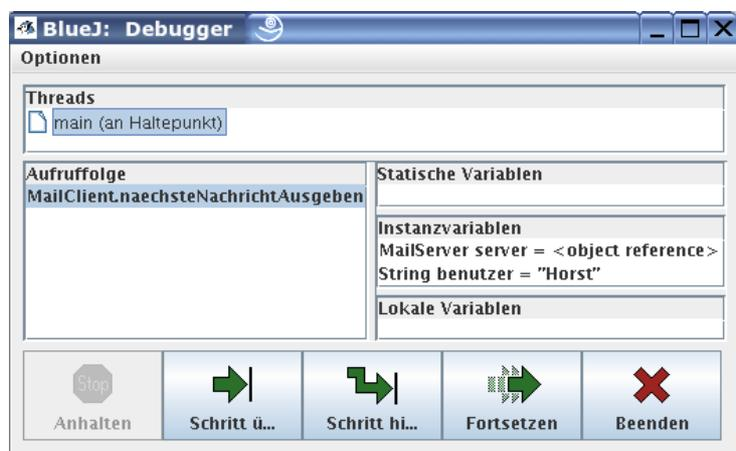
und zu beenden. Neben der schrittweisen Abarbeitung eines Programms mit **Schritt über** bietet der Debugger mit **Schritt hinein** die Möglichkeit, in die aktuelle Anweisung „hineinzuschreiten“ und ihren Ablauf zu inspizieren.
